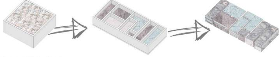
ATIK MUKAVVA VE MAKET KARTONLARININ SU EKLENEREK ÖĞÜTÜLMESİ VE UFALANMASI ARDINDAN DA KÜL, ÇİMENTO VE POLİETİLEN İLE KARIŞTIRILARAK GÜÇLENDİRİLMESİ
